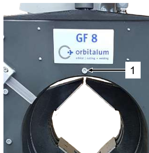
Poloha pojistného šroubu (1) u GF 8, GF 12 (AVM/MVM).
