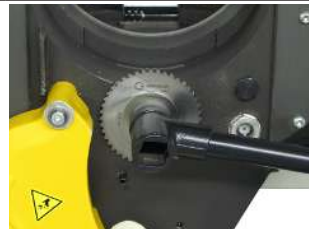
Upevnění pilového listu/frézy
