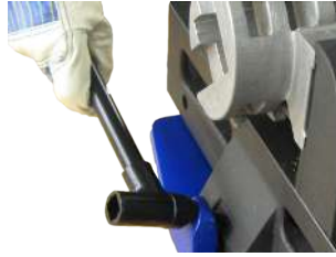
Bevestiging van de zaag op de snelmontageplaat
