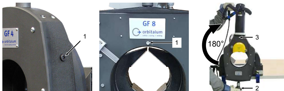
Positie van de borgschroef (1) bij de GF 4 en GF 6 (AAM/HAM). Positie van de borgschroef (1) bij de GF 8 en GF 12 (AAM/HAM).
