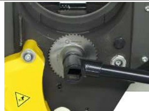
Fixação para lâmina de serra/ fresa
