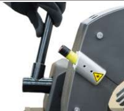
Fixação dos mordentes de aperto (apenas para GF 4 (AVM/MVM))
