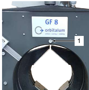
Posição do parafuso de bloqueio (1) na GF 4 e GF 6 (AVM/MVM). Posição do parafuso de bloqueio (1) na GF 8 e GF 12 (AVM/MVM).
