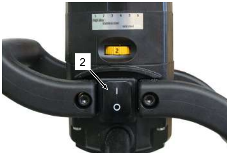
Interruptor basculante de ligar/desligar no motor
