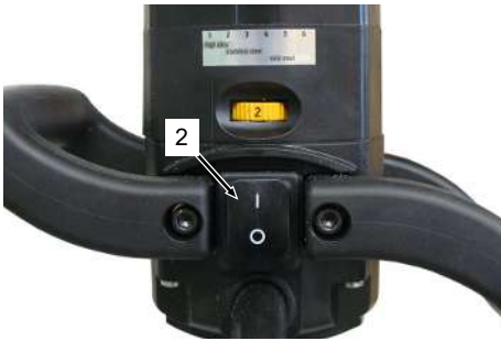
Interruptor basculante de ligar/desligar no motor
