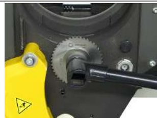
Upevnenie pílového kotúča/frézy
