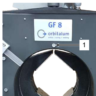
Poloha poistnej skrutky (1) pri GF 8, GF 12 (AVM/MVM).
