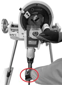
2. Die Spanschraube (2) mit Innensechskantschlüssel lösen.
