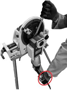
3. Sägeblattnutter (5) mit Gabelringschlüssel SW 22 lösen (Achtung: Linksgewinde!).
