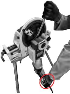
3. 用开口扳手 SW 22 松开锯片螺母 (5) (注意：左旋螺纹！)。
