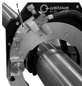
Obr.: Kloubové rameno hořáku v základní pozici
