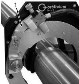
Fig.: braccio articolato della torcia in posizione di base
