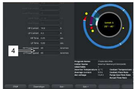
Fig.: posizione torcia e posizione iniziale programma di saldatura in posizione "ore 9"
