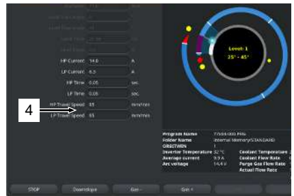
図：溶接プログラムのバーナーと開始の位置、9時の位置
