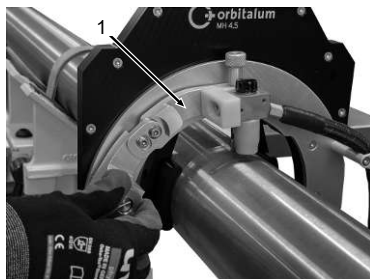
Afb.: Branderscharnierarm in basispositie
