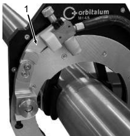
Afb.: Branderscharnierarm in basispositie
