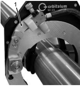
Rys.: ramię przegubowe uchwytu spawalniczego w pozycji wyjściowej
