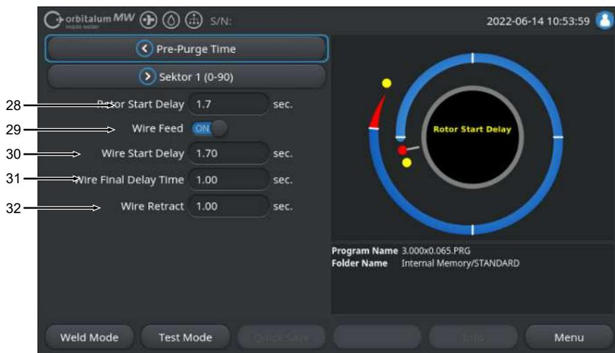
图: 焊接方案段“Motor Start Delay”（电机启动延时）
