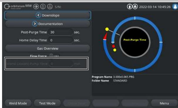
通过“Coolant Delay”（冷却剂延时）功能可在焊接过程以外激活动力源的液体冷却系统。
