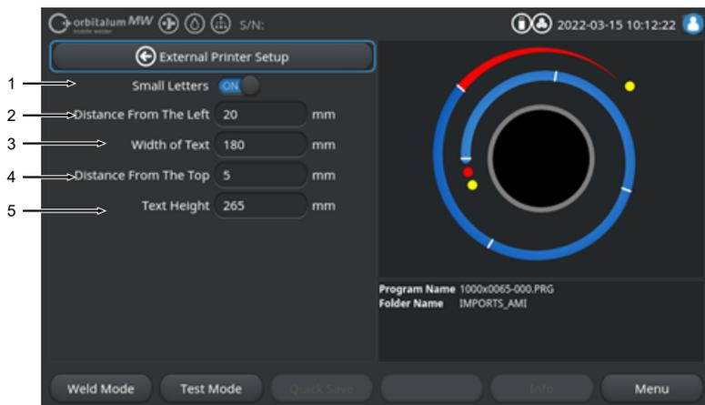
圖：“External Printer Setup”（外接打印机的设置）菜单
