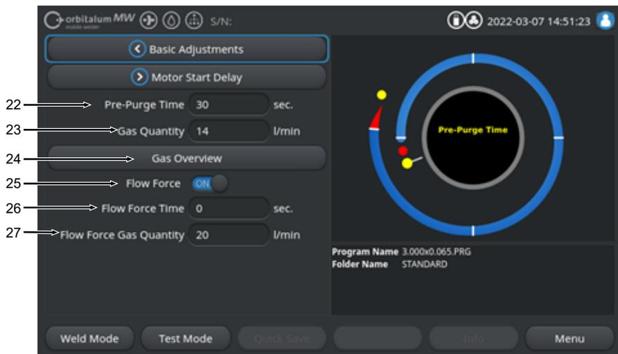
图: “Gas Pre-Purge”（前吹气）焊接方案部分
