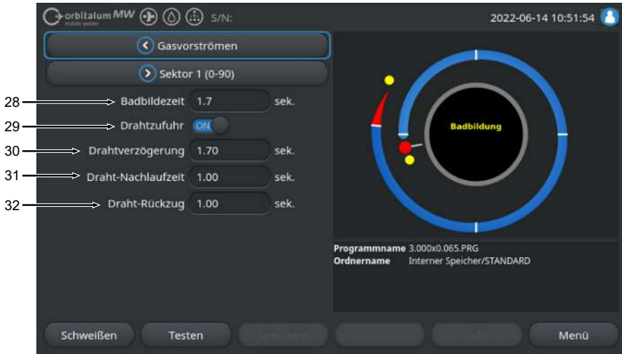
Abb.: Programmabschnitt "Badbildung"
