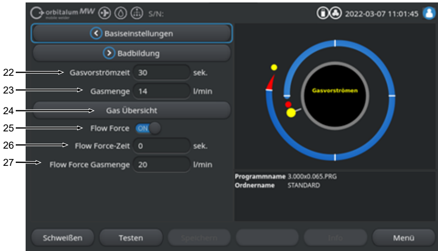
Abb.: Schweißprogrammabschnitt "Gasvorströmen"
