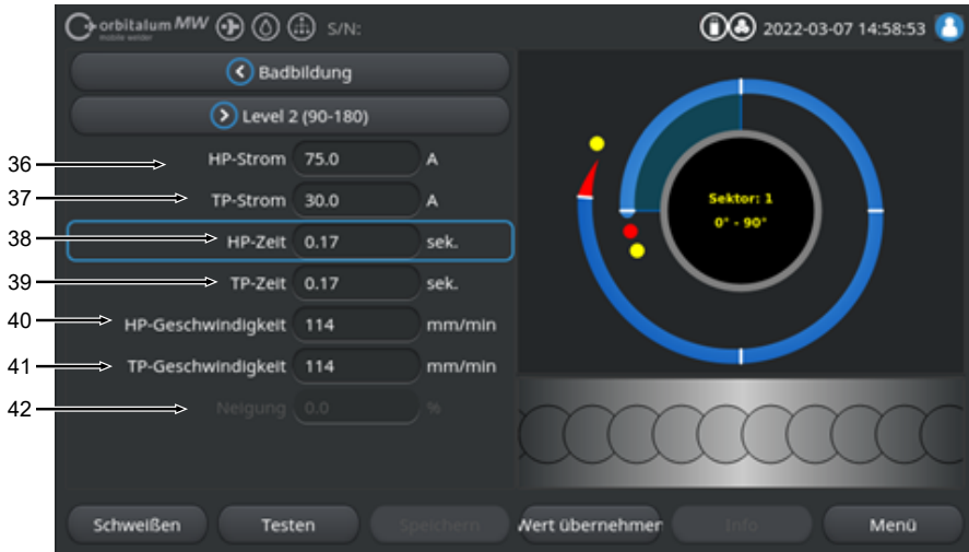
Abb.: Schweißprogrammabschnitt "Sektor"
