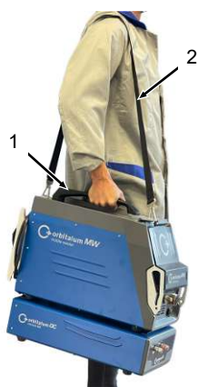
Fig.: Transporte de Mobile Welder
