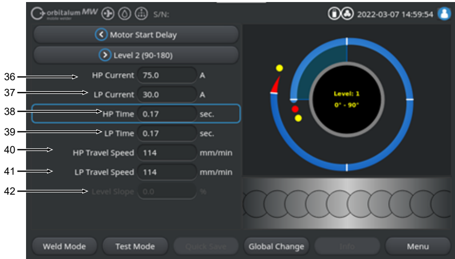
Fig.: Section de programme de soudage Secteur
