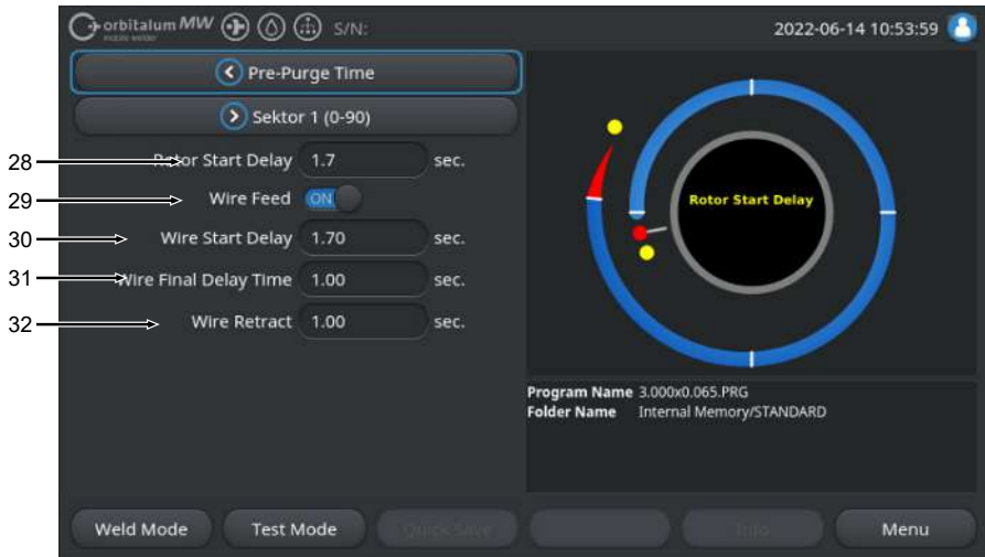
Fig.: Section de programme « Motor Start Delay » (Création du bain de fusion)
