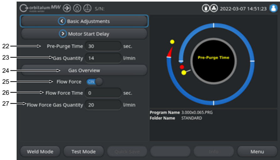
Fig.: Section de programme de soudage « Gas Pre-Purge » (Gaz de pré-purge)
