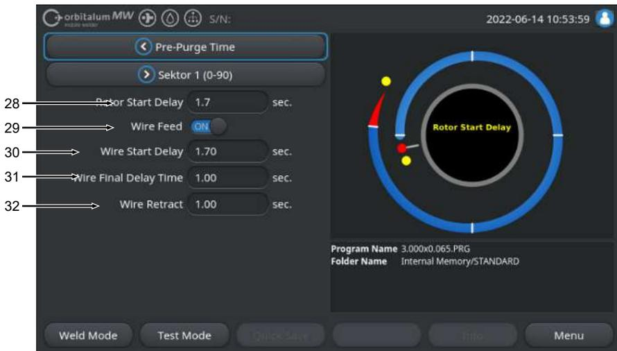
Abb.: Sezione di programma "Rotor Start Delay" (Formazione bagno)
