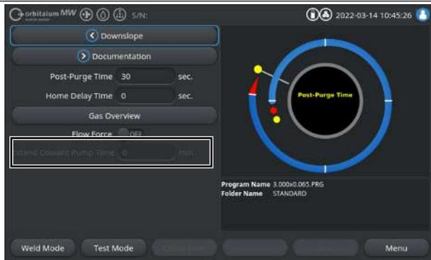
La funzione "Extend Coolant Pump Time" (Utilizza ritardo pompa acqua) permette di attivare il sistema di raffreddamento del generatore di corrente per un periodo di tempo superiore alla durata del processo di saldatura.
