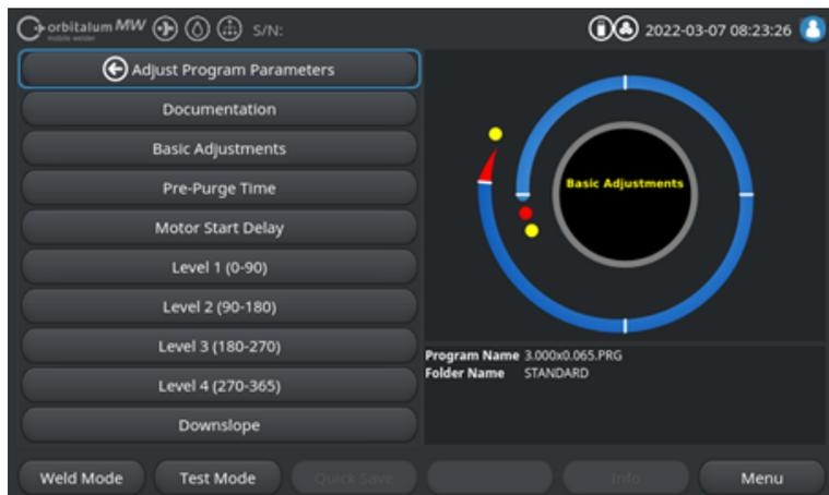
Abb.: Menu "Adjust Program Parameters" (Gestisci parametri)
