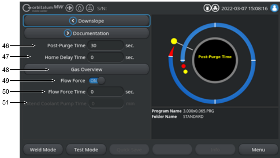
Fig.: "Sectie Gas Post-Purge" (Gas nastroom) van het lasprogramma
