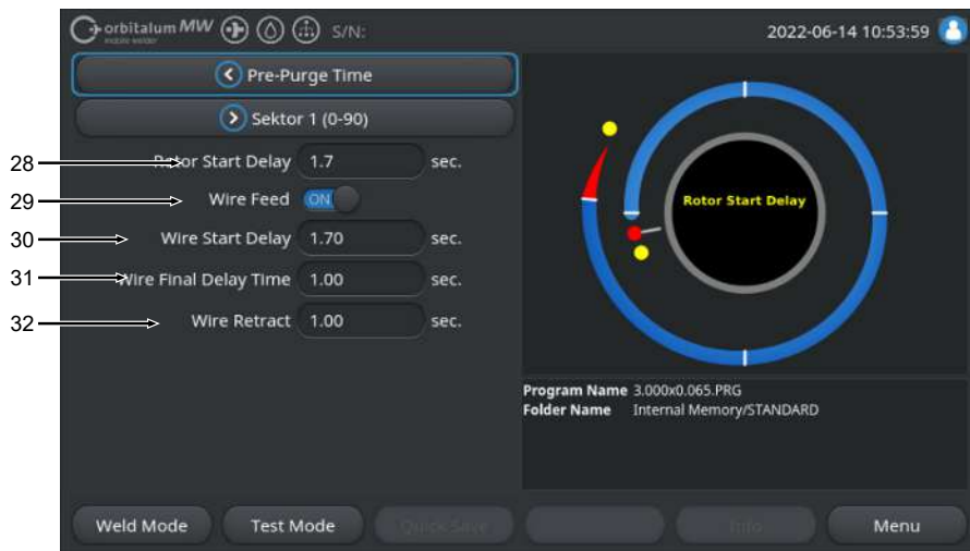
Fig.: Programmasectie "Motor Start Delay" (Smeltbadopbouw)
