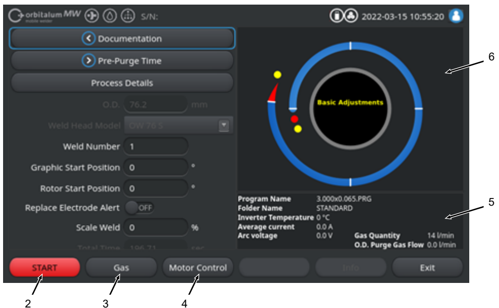
Rys.: Menu „Spawanie”, przycisk programowalny „START” w kolorze czerwonym
