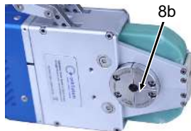
OW 19 mit Spanneinsatz W ("wide")
