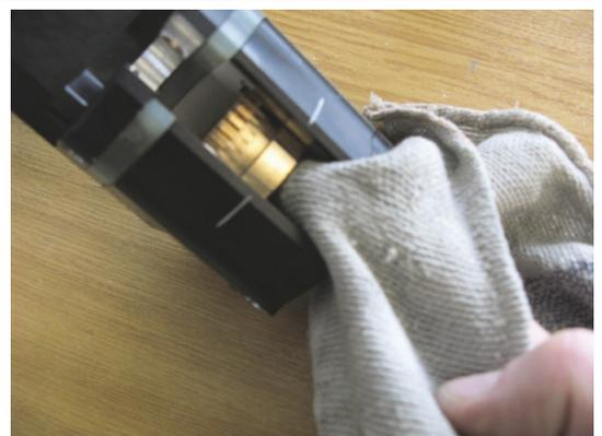
Fig. 10 Strom-/Kühlkontaktfläche mit einem Lappen abwischen
