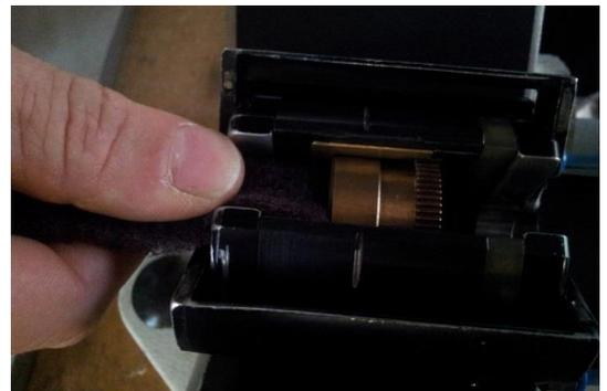
Fig. 6 Reinigen mit Scotch Brite innerhalb des Getriebes
