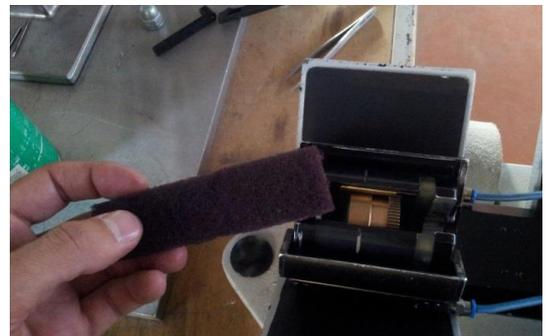
Fig. 5 Reinigen mit Scotch Brite innerhalb des Getriebes
