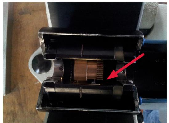
Abb. 1 Startposition für die Reinigung des Rotors
