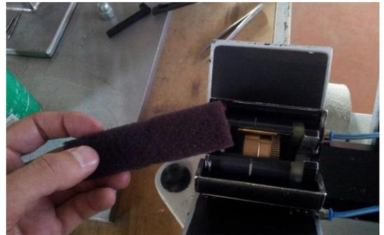
*Fig. 5 Pulizia Interno Corona mediante Scotch Brite*
