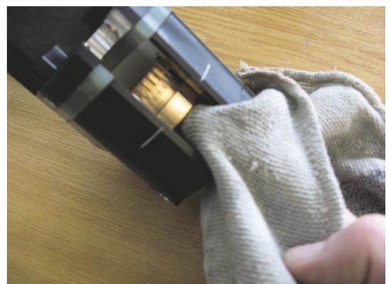
Fig. 10 Pulire la superficie di contatto corrente/raffreddamento con un panno
