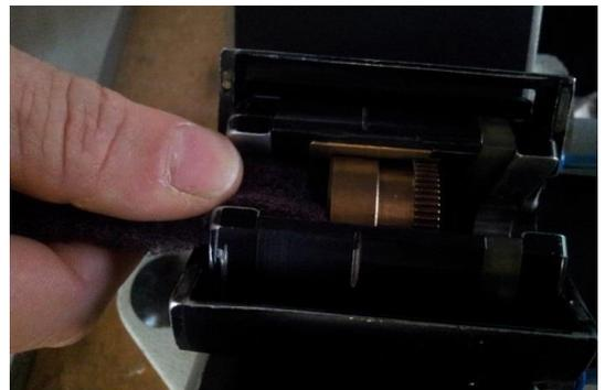
*Fig. 6 Pulizia Interno Corona mediante Scotch Brite*
