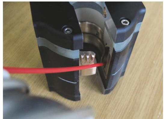
Fig. 9 Spruzzare la superficie di contatto corrente/raffreddamento con un pulitore rapido
