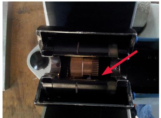
图1清洗齿轮的起始位置
