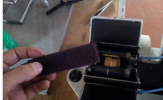
图5用思高scotch brite魔布擦拭齿轮内侧
