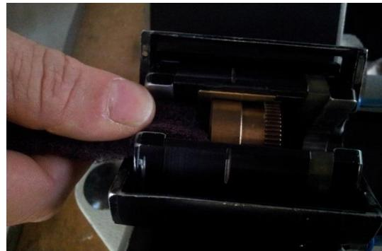
图6 用思高scotch brite魔布擦拭齿轮内侧
