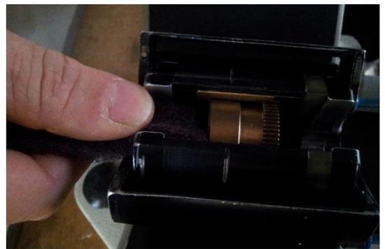
图6用 思高scotch brite魔布擦拭齿轮内侧
