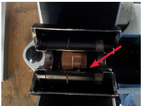
图1清洗齿轮的起始位置
