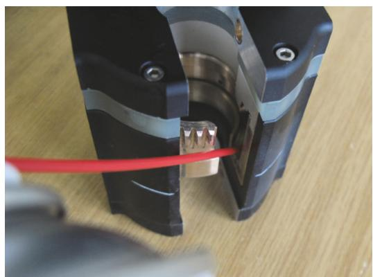
图9 用快速清洁剂喷洒电流/冷却接触面
