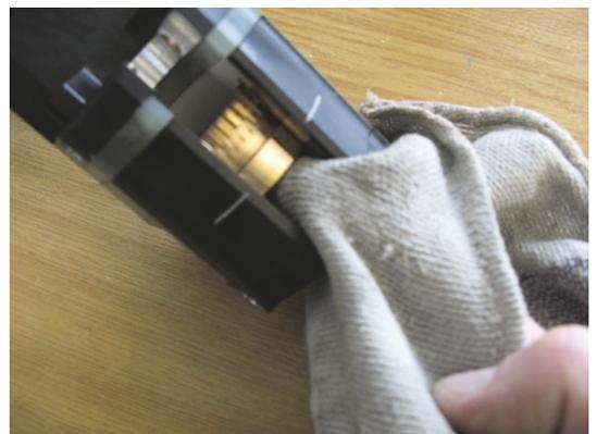
图 10 用布擦拭电流/冷却接触面
