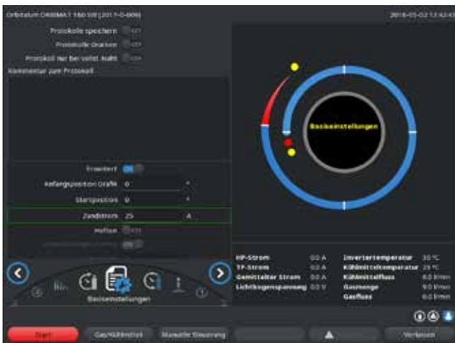
插图 16: 点火电流和熔池形成时间输入文本框
