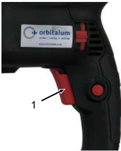
Pulsador ON/OFF de la variante eléctrica
