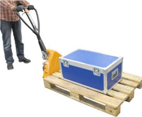
Transport à l'état emballé sur palette et avec l'appareil de manutention approprié (par ex. chariot de levage).
