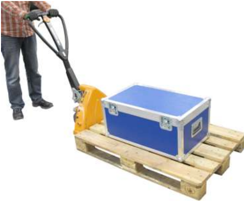
Trasporto della macchina imballata su un bancale con un mezzo di trasporto adatto (ad esempio carrello elevatore).
