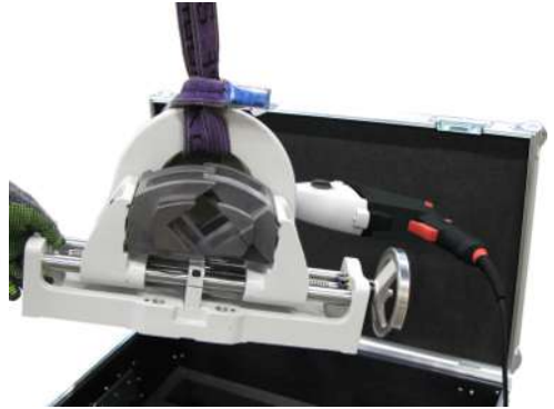
Rimozione e ricollocamento della macchina nell'imballaggio.
