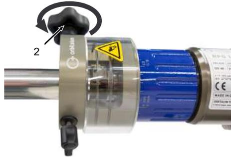
Spannschraube (2) RPG 1.5 lösen
