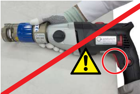
Fig.: Touche MARCHE/ARRÊT pressée contre l'établi
