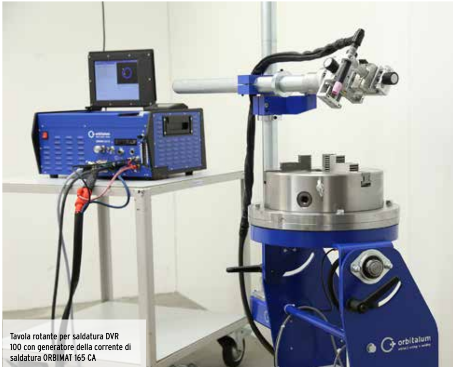
Mandrino a tre griffe per il posizionamento e il fissaggio precisi del pezzo da saldare
