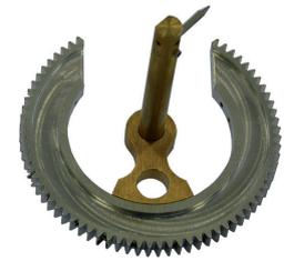
Adaptateur de soudage intérieur (sans rotor)
