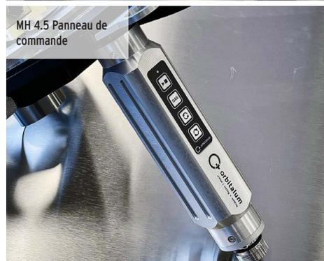
**Les têtes de soudage orbital ouvertes de la série MH s'utilisent partout où des tubes en acier inoxydable à paroi mince doivent être soudés dans la construction de conduites de tuyau. Leur construction est compacte et elles sont dotées d'un boîtier de têtes de soudage étroit si bien que le soudage est possible même lors de situations de montage étroites. Le modèle Mobile Head est compatible avec les générateurs de soudage orbital des séries SW et Mobile Welder.**
