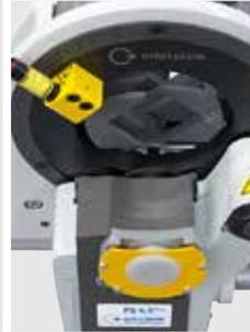
Zweite Sägeblattaufnahme zum Herausstreifen von Rohrbögen
