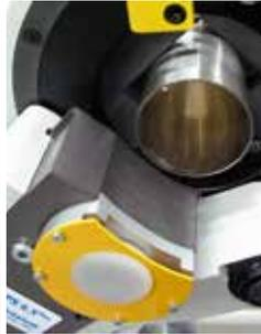
Principe de la coupe planétaire éprouvée : la lame de scie plonge dans la coupe et est guidée orbitalement autour du tube
