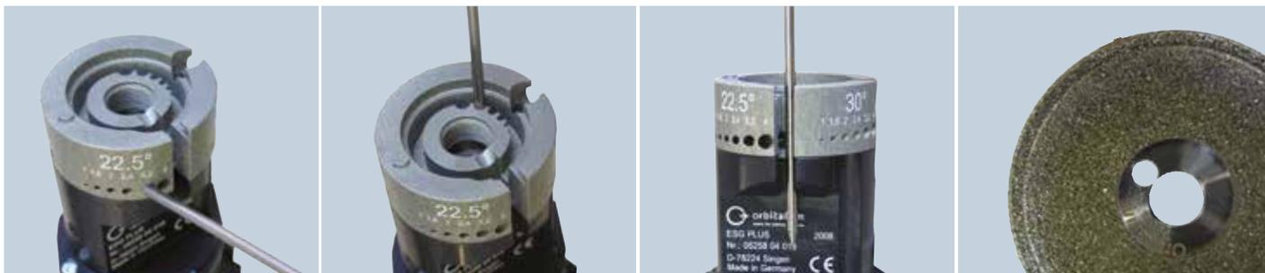
Affilatura di elettrodi: 4 angoli diversi, 6 diametri dell'elettrodo diversi
