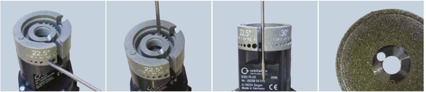
Elektroden anschleifen: 4 unterschiedliche Winkel, 6 unterschiedliche Elektroden-durchmesser
