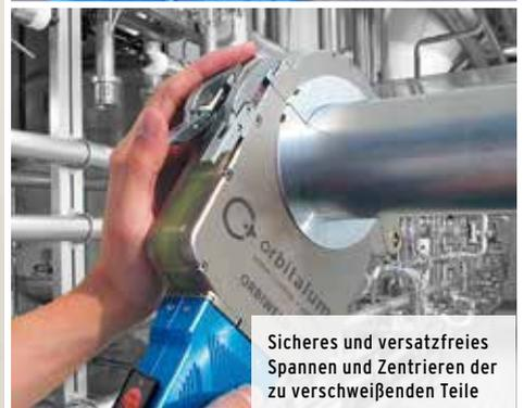
Sicheres und versatzfreies Spannen und Zentrieren der zu verschweißenden Teile
