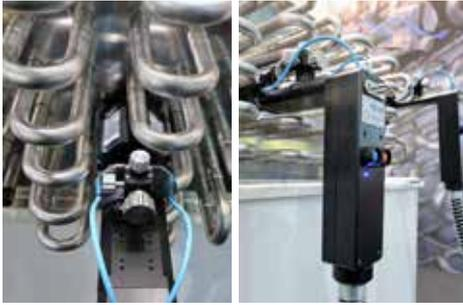
Extrem schmale Bauform - ideal für das Verschweißen vormontierter Bögen in engen Rohrbündeln
