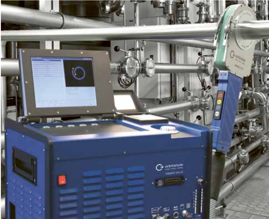
Moniteur orientable de 10,5" et imprimante système intégrée
