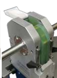
Coperchio della testa di saldatura incernierato "FlipCover"
