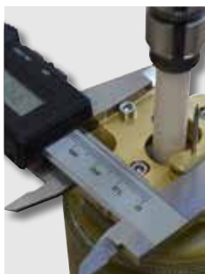
Regolazione semplice e precisa della posizione dell'elettrodo
