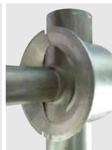
Collari di serraggio per saldatura di raccorderia "T" con possibilità di montaggio del tubo allargato e del tubo da saldare
