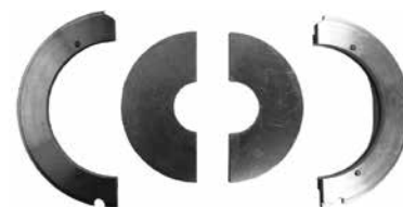
Collare per la saldatura di curve (sede/disco di centraggio)
