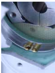
Montaggio più facile degli elettrodi grazie ai segni per Ø 1,0/1,6 mm (0.039"/0.063")
