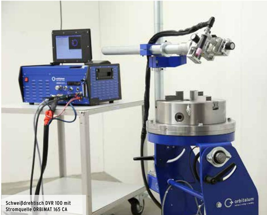
Schweißdrehmaschine DVR 100 mit Stromquelle ORBIMAT 165 CA
