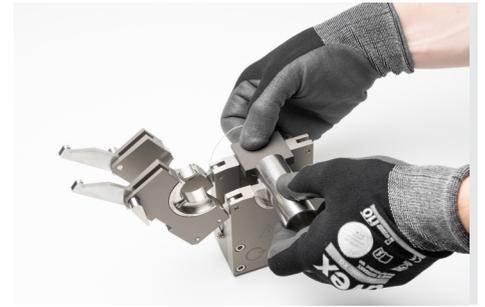
Eine an die Spannkassette befestigte und dadurch unverlierbare Rohrmittellehre stellt die exakte Positionierung des zu verschweißenden Rohrstoßes sicher.
