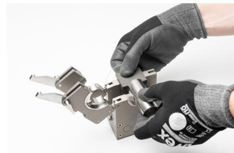
Un calibro di centratura del tubo montato sulla cassetta di serraggio assicura l'esatto posizionamento del giunto da saldare.
