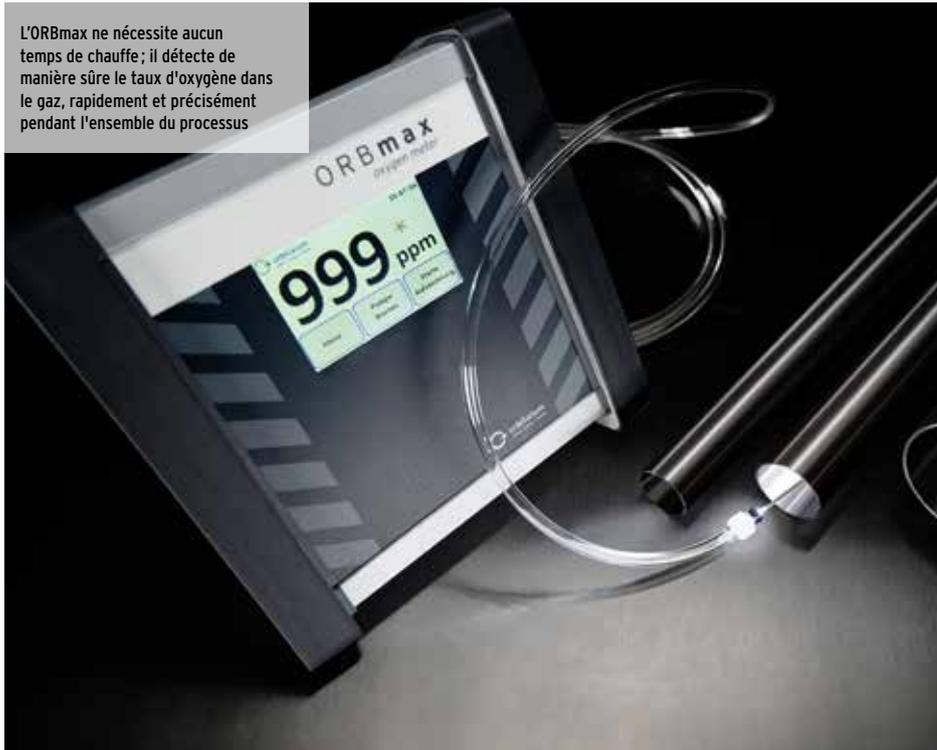
L'ORBmax ne nécessite aucun temps de chauffe; il détecte de manière sûre le taux d'oxygène dans le gaz, rapidement et précisément pendant l'ensemble du processus
