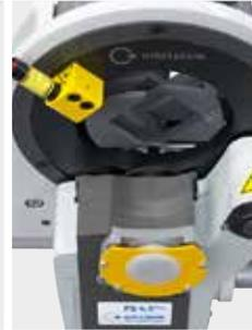
Secondo supporto della lama per il taglio di curve
